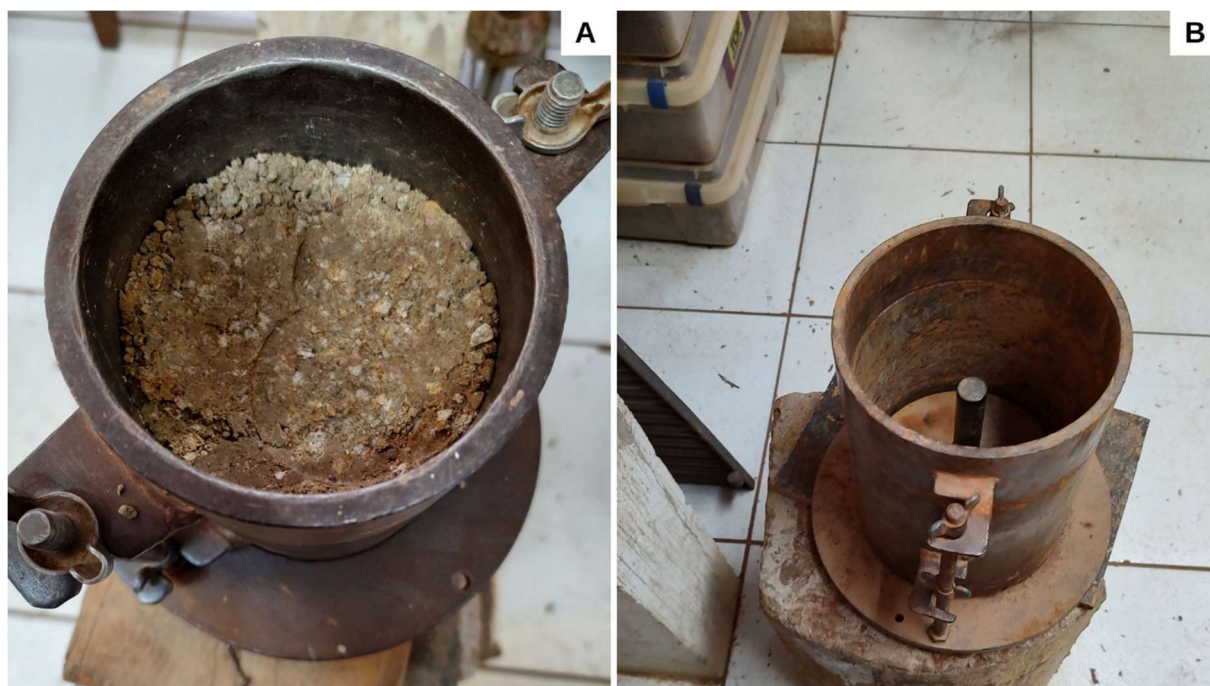
Figura 7. (A) Cilindro preenchido e compactado; (B) Cilindro pequeno.
