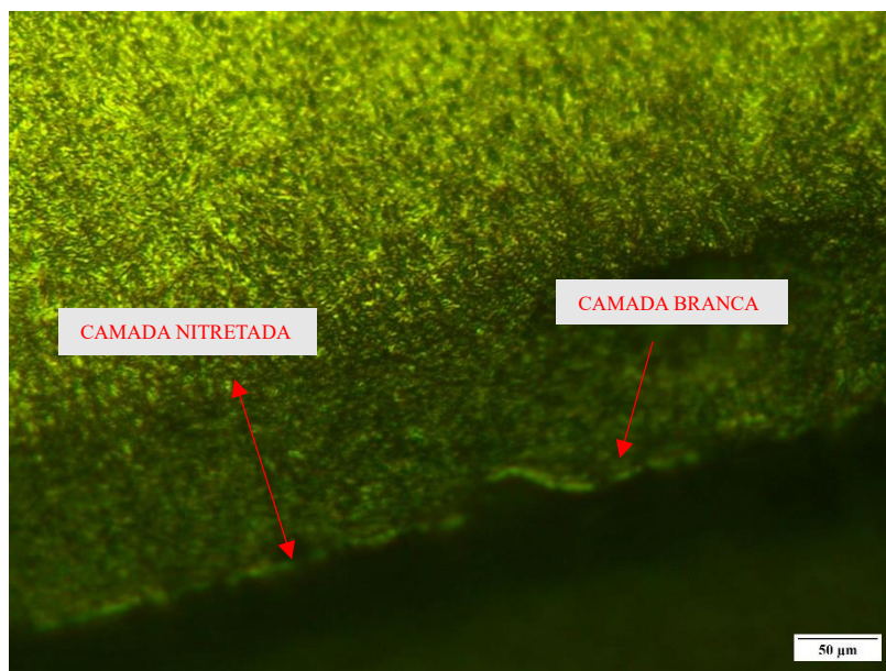
Figura 26 - Microscopia Óptica AISI H13: T/R/C/N/R - 400X. Ataque Nital 3%.
