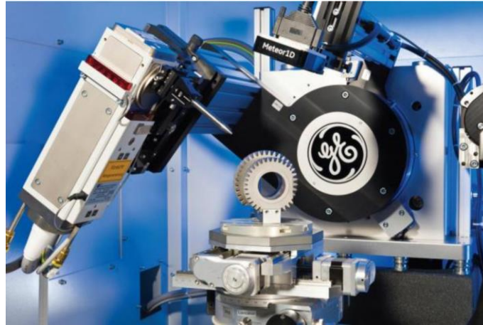
Figura 15 Equipamento para medição de tensões residuais
