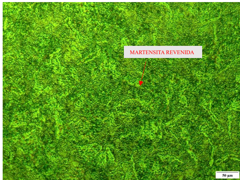
Figura 22 - Microscopia Óptica AISI H13: T/2R - 400X. Ataque Nital 3%.
