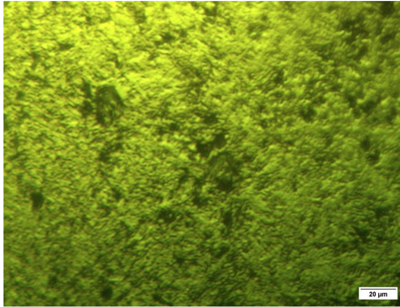
Figura 27 - Microscopia Óptica AISI H13: T/R/C/N/R - 1000X. Ataque Nital 3%.
