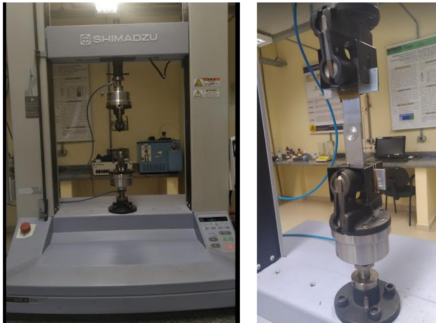
Figura 17 - a) Shimadzu AGS-X 5kN. B) Representação do ensaio.
