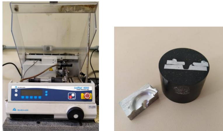
Figura 20 - a) Buehler Isomet 4000. b) Botão de solda e corpo de prova
