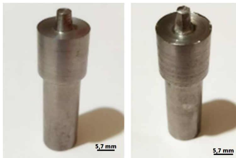
Figura 14: Ferramentas investigadas: a) pino cônico convencional e b) pino sextavado.
