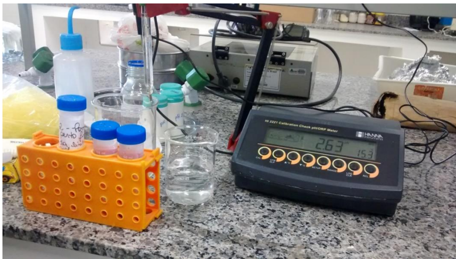
Figura 27 - Ajustando o pH das amostras de água para a conservação dos metais
