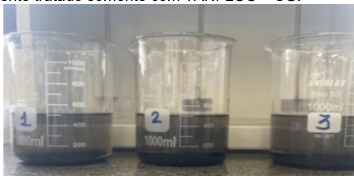
Figura 14 – Efluente tratado somente com TANFLOC – SG.
