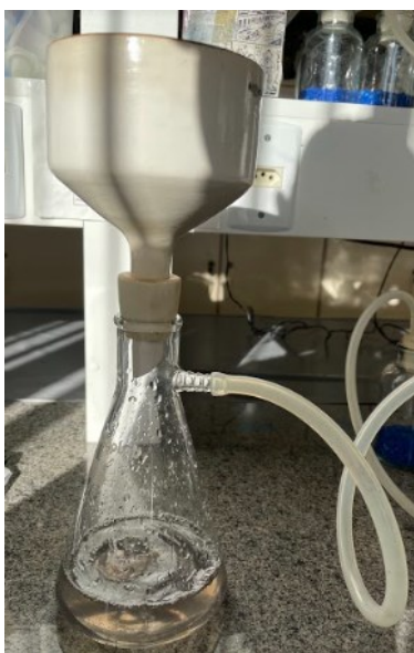
Figura 15 – Filtração das amostras.
