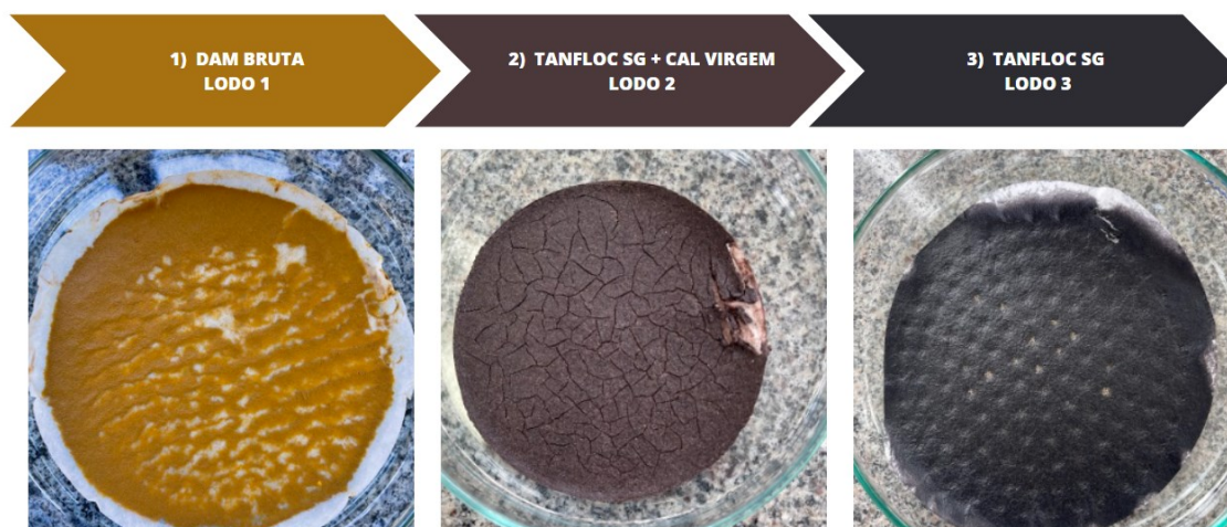
Figura 17 – Lodo pós filtração de cada amostra.
