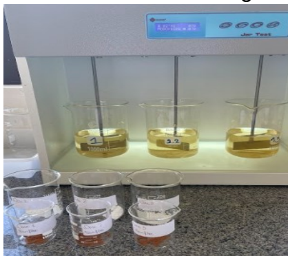
Figura 12 – Jar-Teste com amostra Bruta e Reagentes.
