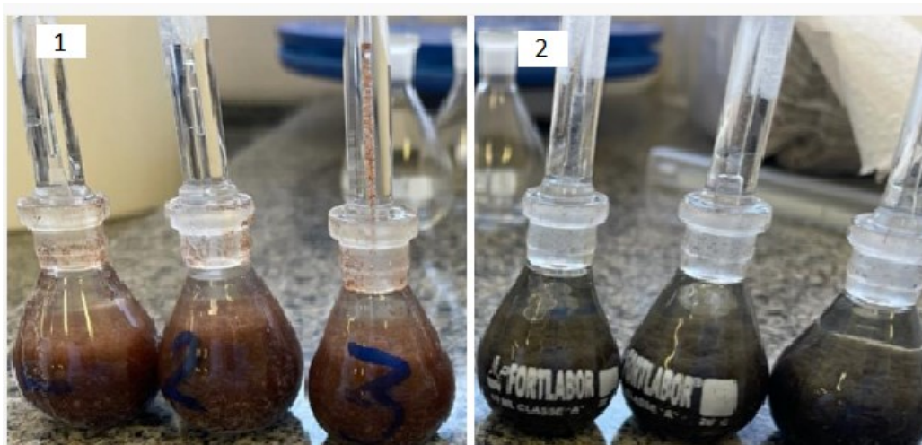
Figura 16 – Picnometria: 1) TANFLOC – SG + Cal Hidratada; 2) TANFLOC – SG.
