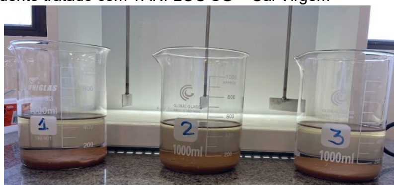
Figura 13 – Efluente tratado com TANFLOC SG + Cal Virgem
