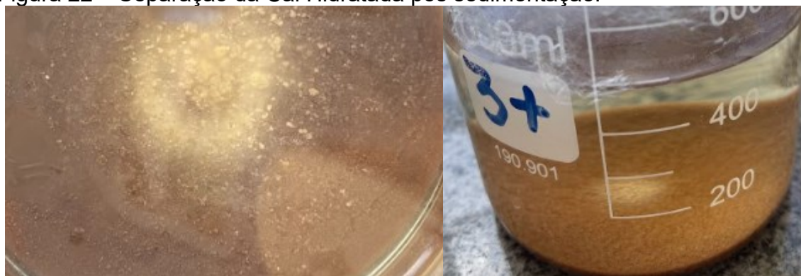
Figura 22 – Separação da Cal Hidratada pós sedimentação.
