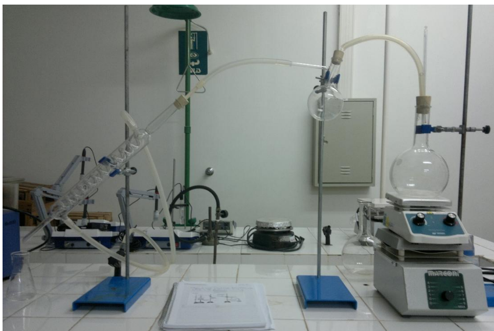
Figura 12 - 2ª tentativa da montagem do sistema de extração por arraste a vapor Fonte: Almeida, L. O. (2015).
