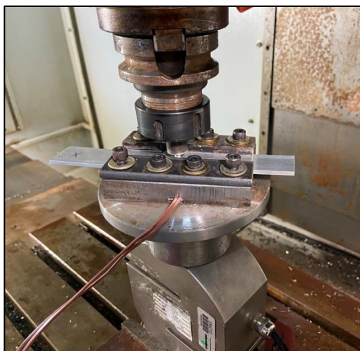
Figura 17 – Detalhe mostrando o gabarito de soldagem, chapas, célula de carga e cabeamento dos termopares
