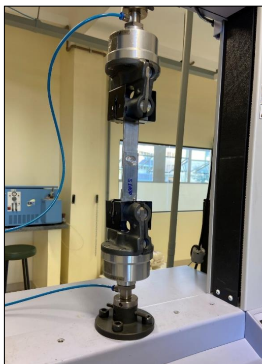
Figura 18 – Ensaio de Cisalhamento: (a) máquina universal de ensaios Shimadzu AGS-X e (b) detalhe de um corpo de prova durante ensaio de cisalhamento.
