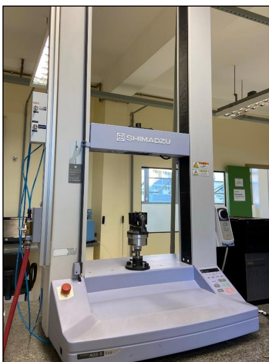
Figura 18 – Ensaio de Cisalhamento: (a) máquina universal de ensaios Shimadzu AGS-X e (b) detalhe de um corpo de prova durante ensaio de cisalhamento.
