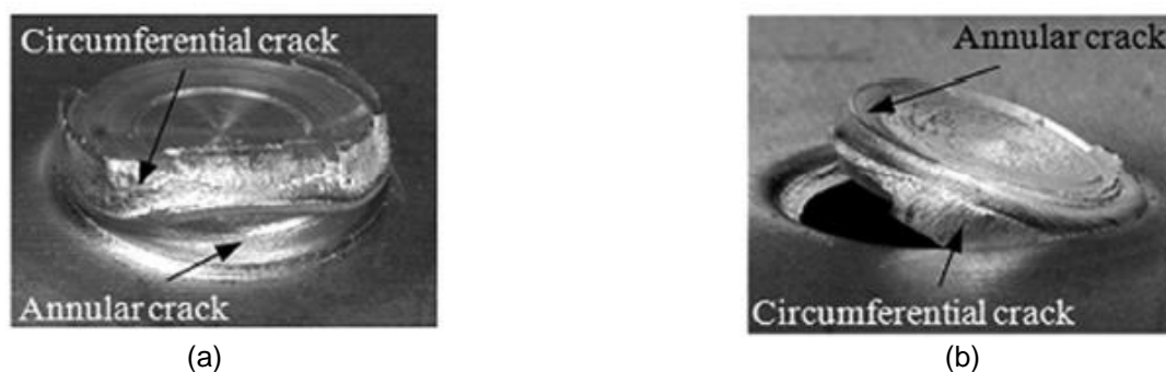
Figura 2 – Modos de fratura de juntas sobrepostas de AA6181-T4 soldadas pelo processo Refill FSSW: (a) extração parcial com rasgo (b) através da solda.
