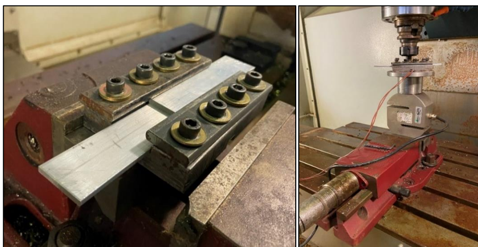
Figura 15 – Equipamento de soldagem no centro de usinagem CNC: (a) gabarito de soldagem e (b) setup utilizado nas soldagens.
