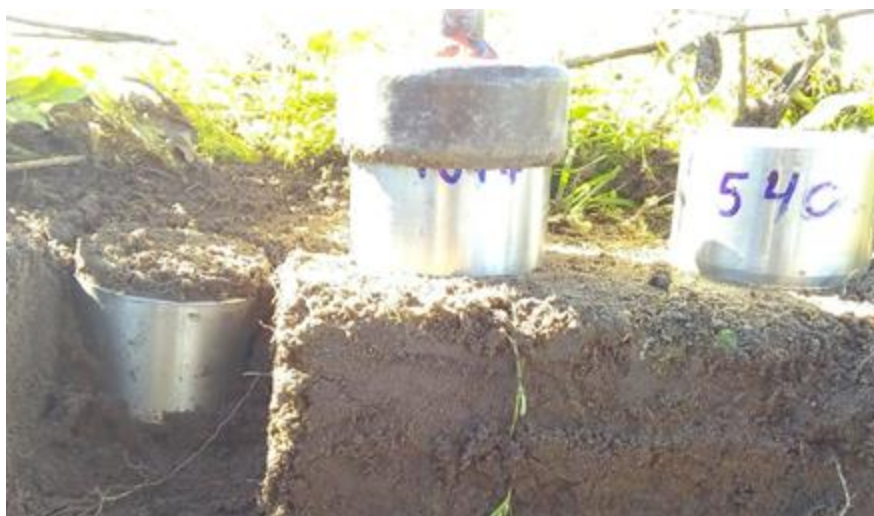
Figura 6: Coleta de amostra indeformadas em cilindro metálico.
