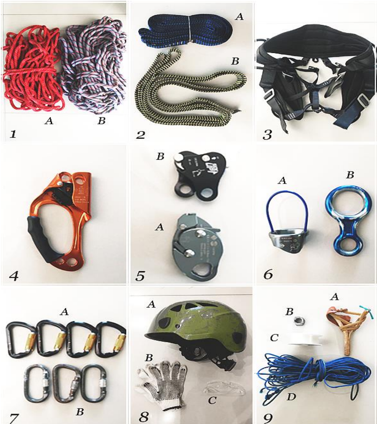
Figura. Equipamento de escalada: (1A) corda de ascensão estática, (1B) corda de segurança dinâmica, (2A) fita 2m, (2B) fita 1,5m, (3) cadeirinha, (4) ascensor, (5A) blocante corda de ascensão, (5B) blocante corda de segurança, (6A) freio atc, (6B) freio 8, (7A) mosquetões de alumínio, (7B) mosquetões de aço, (8A) capacete, (8B) luvas, (8C) óculos e (9A) estilingue, (9B) balim, (9C) linha de nylon e (9D) cordelete.
