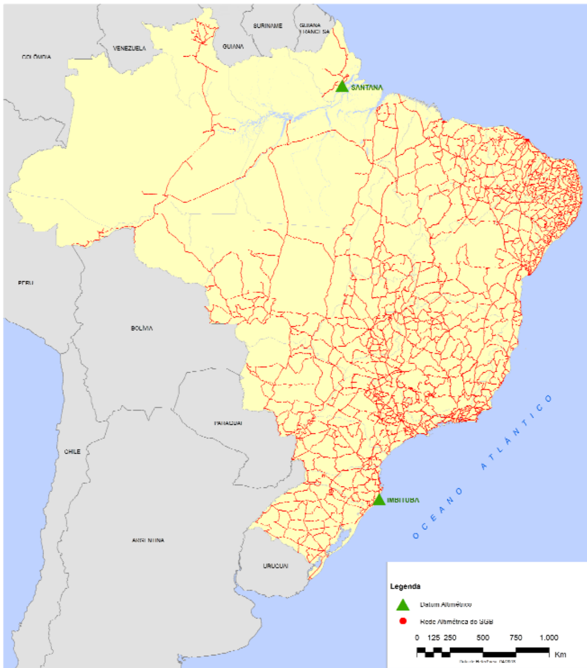
Figura 2: Representação da Rede Altimétrica de Alta Precisão - RAAP
