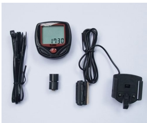
Figura 3.18: odômetro digital utilizado para verificar a movimentação das pás.
