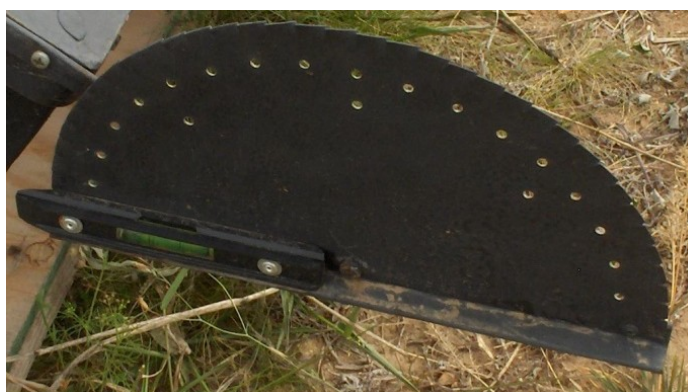
Figura 4.2: mecanismo para determinar a inclinação das placas
