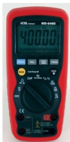
Figura 3.16: multíteste ICEL MD-6490 utilizado com termopar para medição de temperaturas
