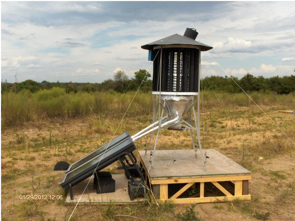
Figura 4.7: secador solar finalizado e instalado na UNIPAMPA- Campus Bagé
