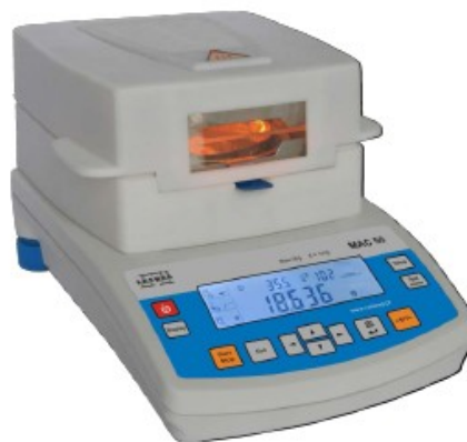
Figura 3.19: balança de medição de umidade Radwag Modelo MAC210 utilizada na determinação da umidade da biomassa
