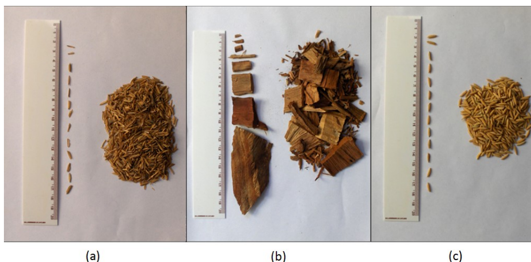
Figura 3.20: granulometria das biomassas testas no secador solar: (a) casca de arroz, (b) cavaco e (c) arroz com casca
