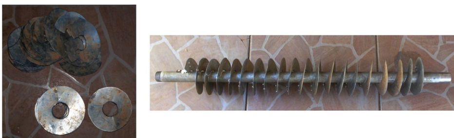
Figura 4.6: montagem da rosca nua que compõe o centro do equipamento de revolvimento
