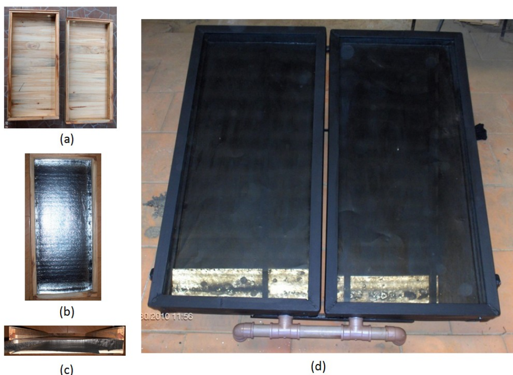
Figura 4.1: montagem das placas solares – (a) base em madeira das placas, (b) isolamento interno das placas, (c) colocação da chapa em aço galvanizado e (d) conjunto final das placas.
