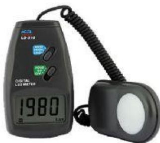
Figura 3.17: luxímetro digital Politem, modelo LX1010B utilizado para medir a radiação recebida pelas placas
