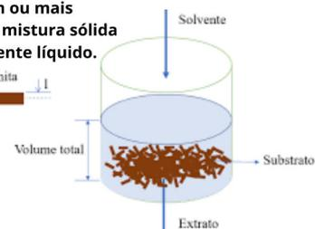
Neste processo ocorrem as seguintes etapas: contato do solvente com o sólido, que lhe cede o componente solúvel; separação da solução do sólido remanescente por filtração; destilação ou evaporação, para recuperação do soluto dissolvido no líquido extrator.
