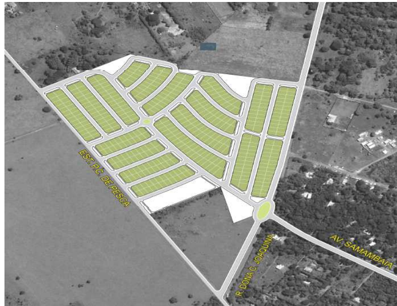
Figura 7 – Representação esquemática da distribuição de quadras e lotes
