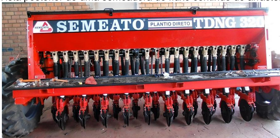
Figura 2 - Vista posterior de uma semeadora de fluxo contínuo de arrasto.
