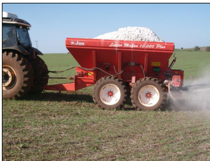
Figura 6 - Aplicação do calcário e fertilizantes à taxa variável.
