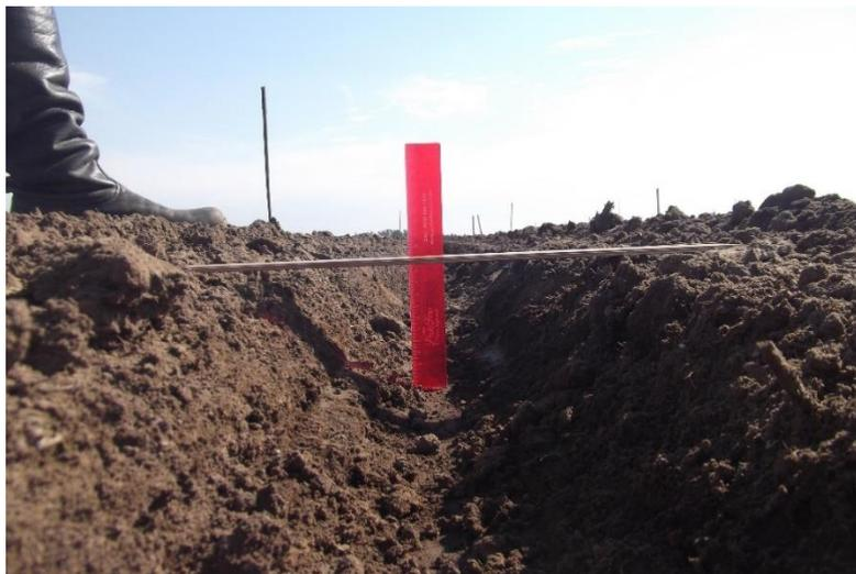
Figura 11 - Determinação da profundidade do sulco entre camalhões. Itaqui-RS, 2013.
