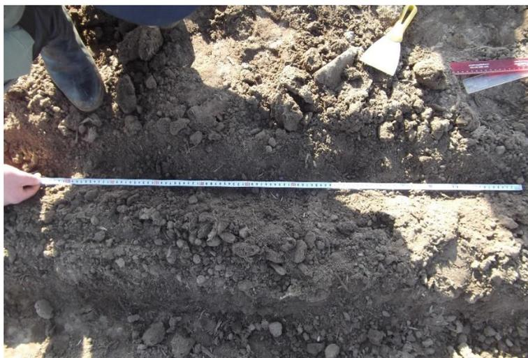
Figura 9 - Determinação da uniformidade de distribuição longitudinal de sementes. Itaqui-RS, 2013.
