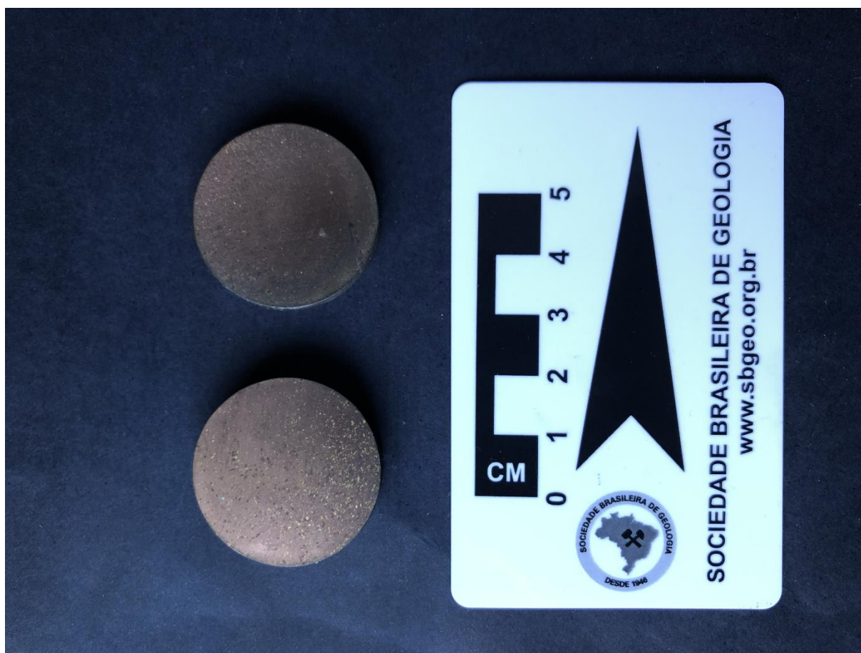
Figura 10 - Pastilhas confeccionadas para análise do MEV-EDS.
