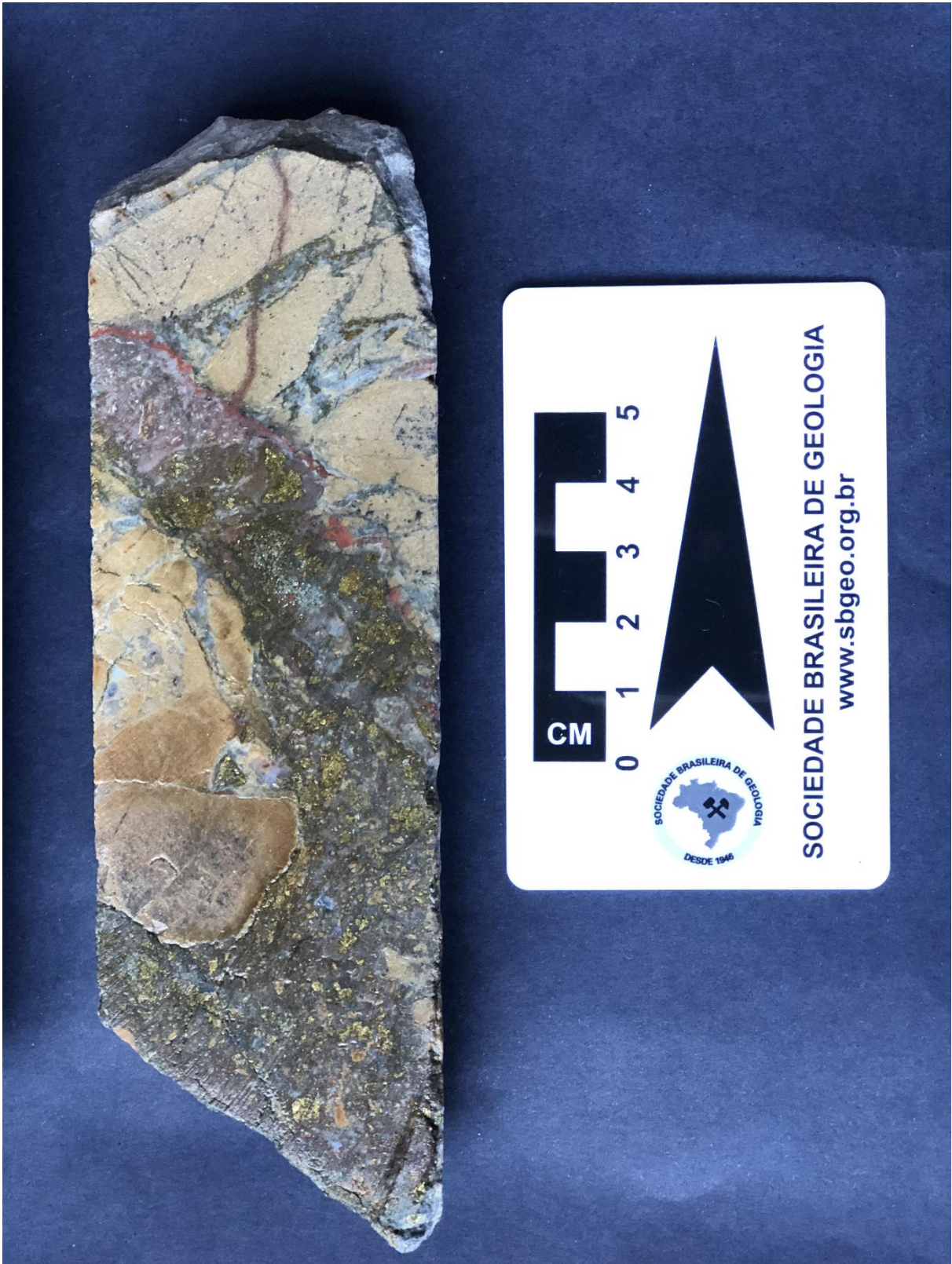
Figura 25 - Amostra de cobre onde é possível notar as mineralizações de sulfetos de cobre e ferro (coloração amarelada) e alguns veios preenchidos por hematita (coloração avermelhada) presentes na rocha.
