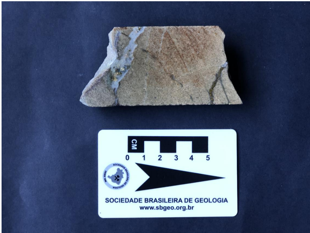
Figura 21- Amostra de cobre indicando a presença de mineralizações e veios preenchidos por caulinita.
