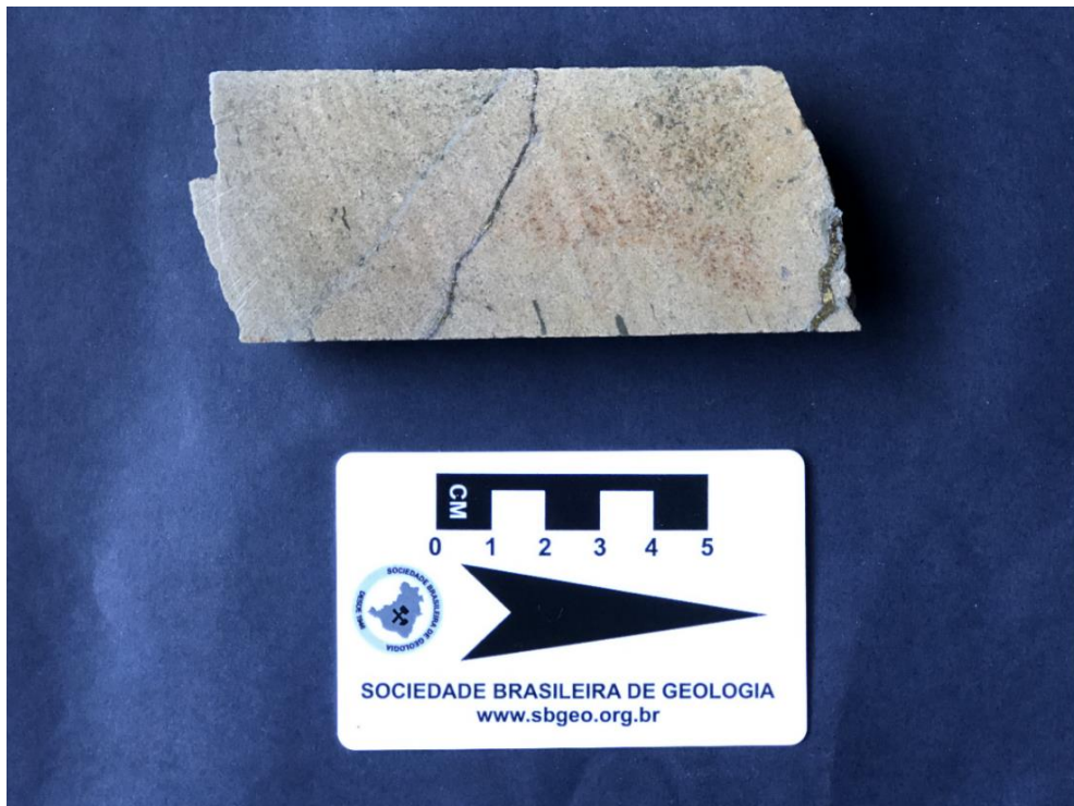
Figura 22 - Amostra de cobre evidenciando a classificação de arenito bem selecionado de textura fina a muito fina e coloração acinzentada.
