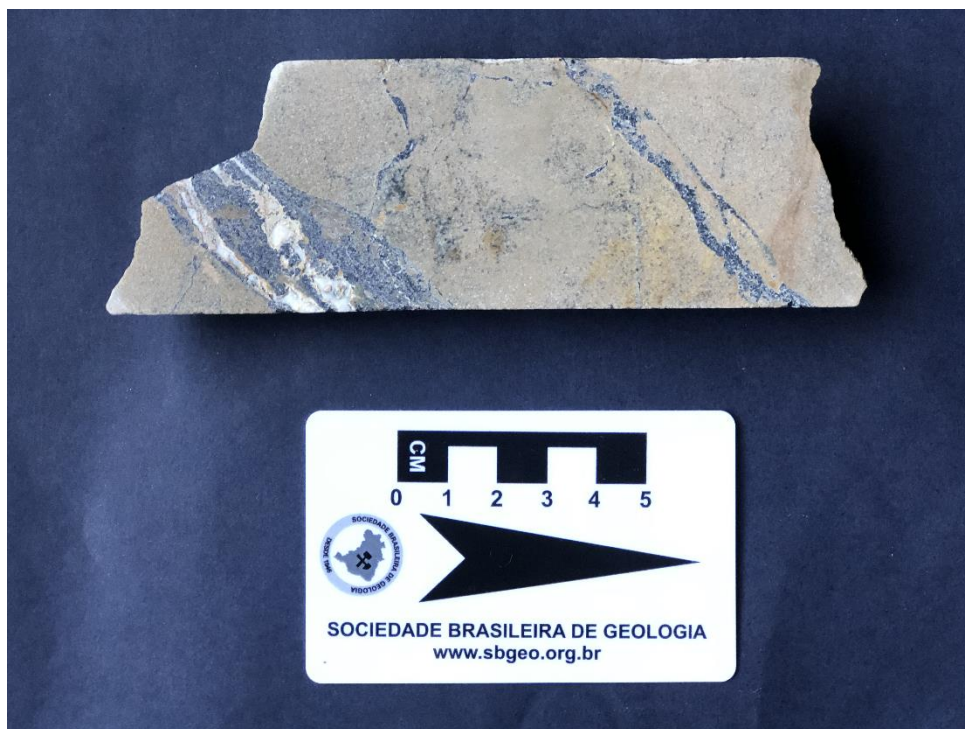
Figura 24 - Veios grossos de sulfetos de Cu e Fe circundando veios de calcita.
