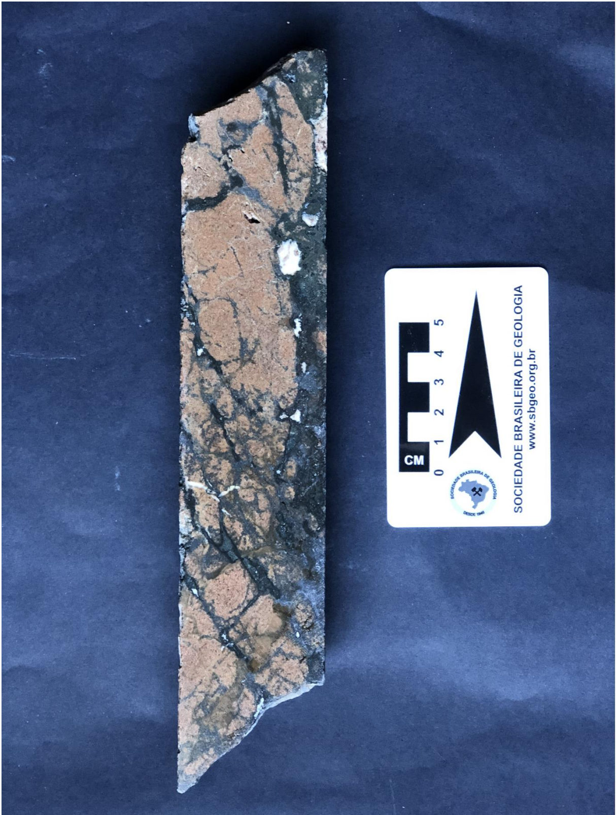
Figura 16 - Amostra de Pb-Zn com mineralizações massivas de galena e esfalerita e presença de concentrações de minerais carbonáticos.
