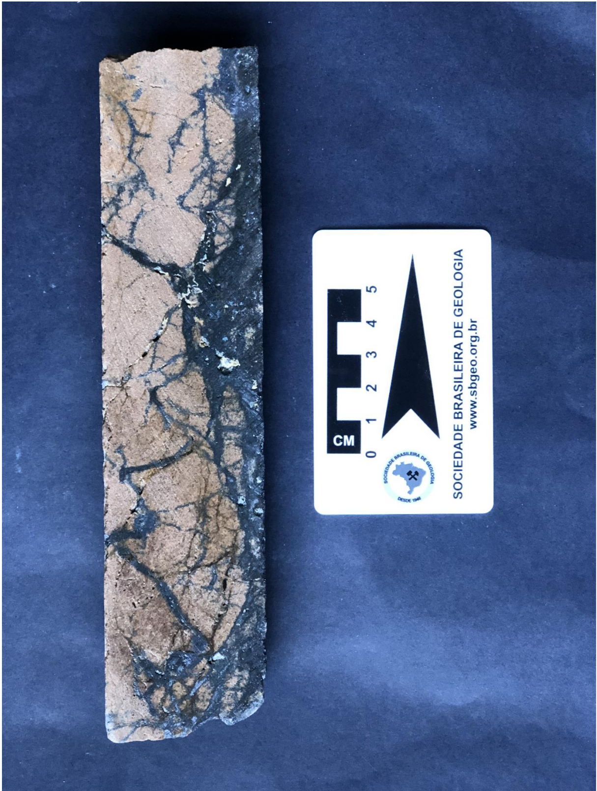
Figura 15 - Amostra de Pb-Zn com mineralizações massivas de galena e esfalerita e presença de minerais carbonáticos preenchendo as cavidades pré-existentes da rocha.
