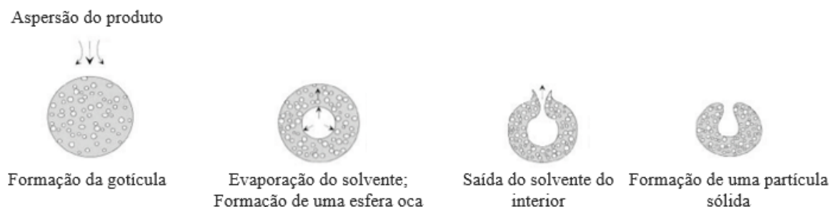
Figura 7 - Formação da partícula por secagem por spray drying
