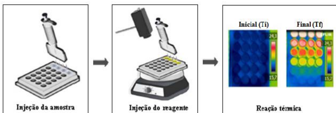
FIGURA 2 - Processo de execução da análise de TIE e reação térmica observada através da câmera de infravermelho após injeção do reagente.
