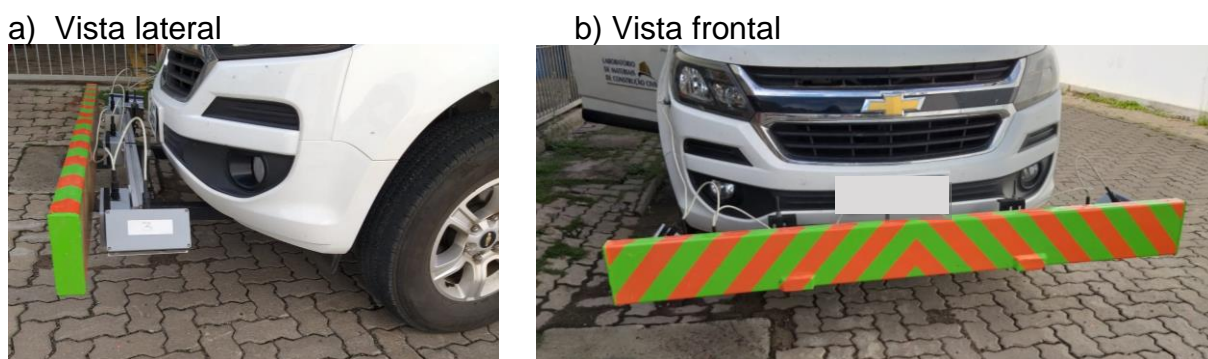
Figura 20 – Ciberlaser acoplado no veículo utilizado para estudo
