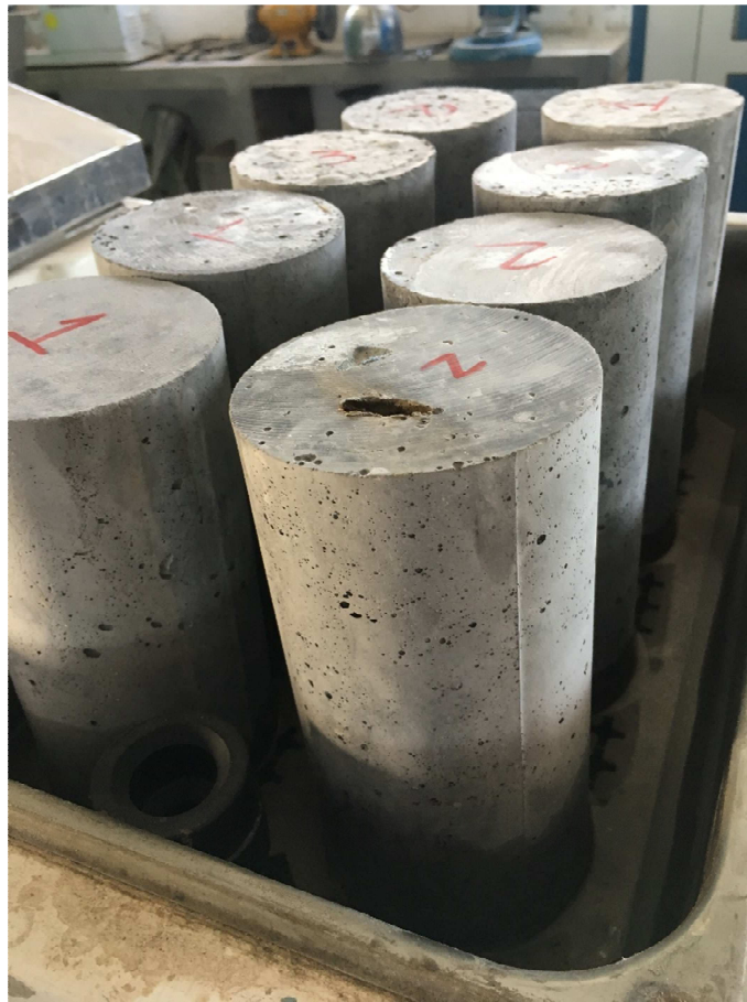
Figura 09 – Corpos de Prova submetidos ao ensaio de absorção
