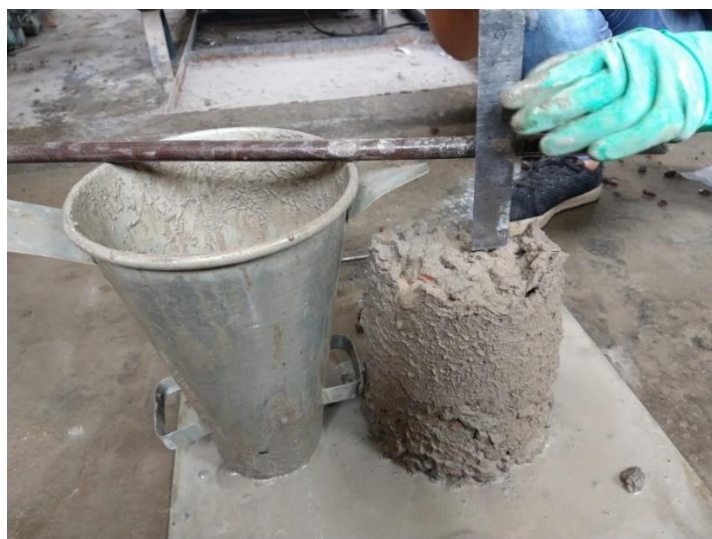
Figura 11 – Ensaio de Slump Test
