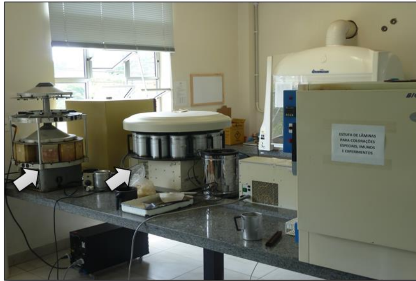
FIGURA 6 - Dois aparelhos histotécnicos (setas) e estufa utilizada para processamento dos fragmentos clivados. Fonte o autor.
