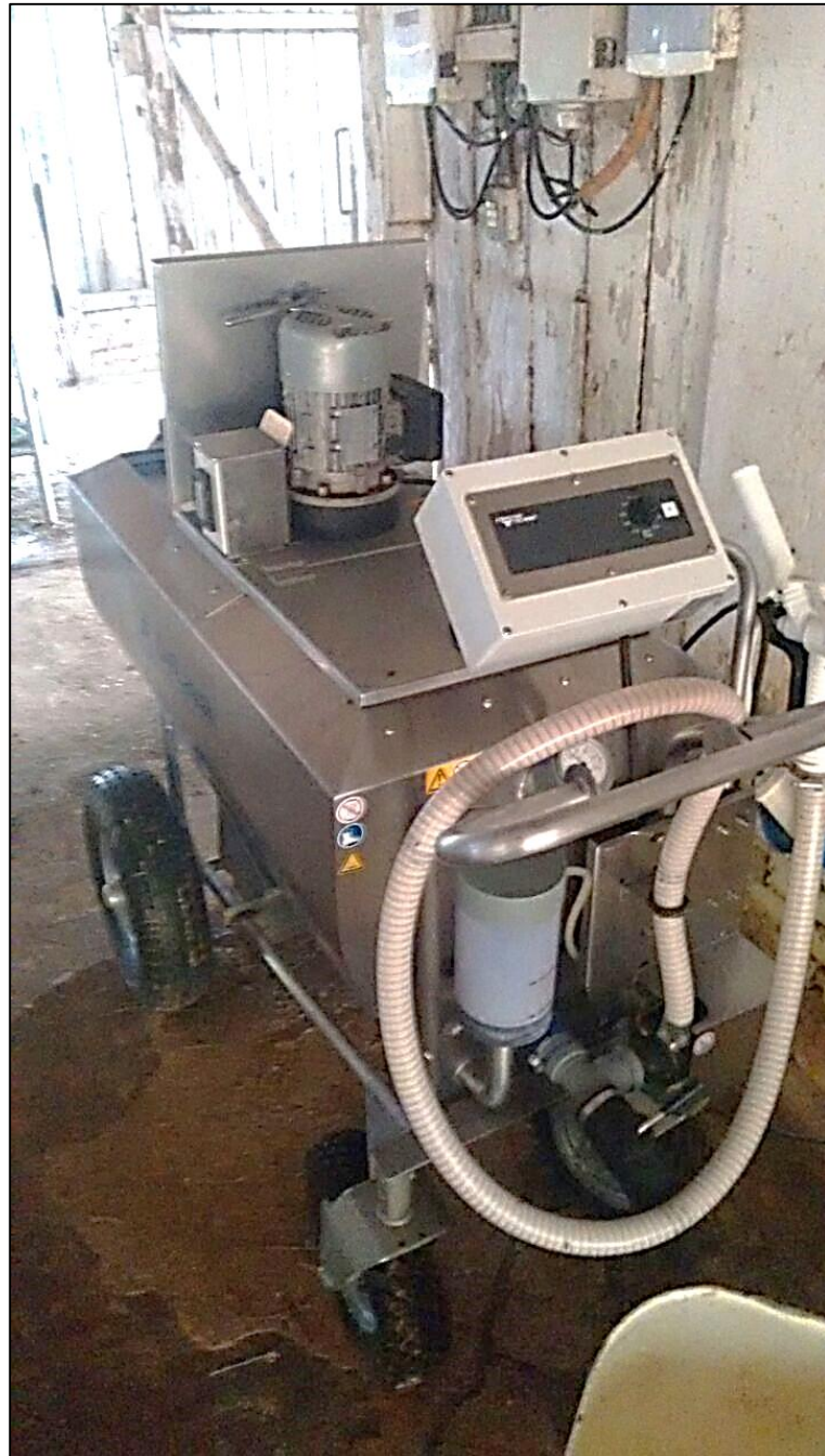
FIGURA 9 - Alimentador automático para terneiras De Laval.
