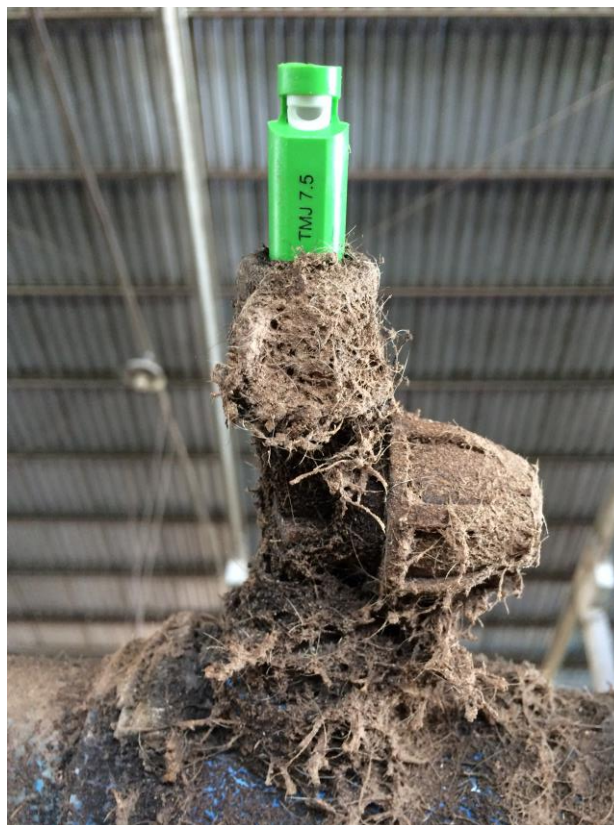
FIGURA 13 - Bico de nebulização sobre a linha de cocho.
