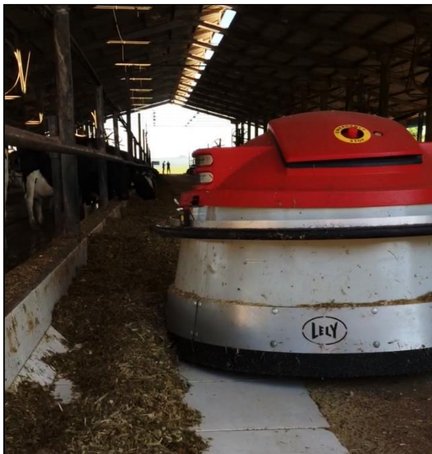
FIGURA 8 - Lely Juno. Robô adquirido pela fazenda para aproximar o TMR na linha de cocho.
