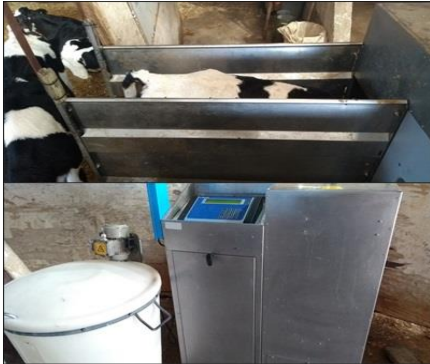
FIGURA 13- Amamentador automático do tipo CF 150X da Delaval. Fazenda Fini.
