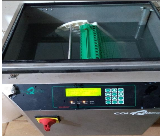
FIGURA 9- Aparelho ColoQuick para aquecimento de colostro em banho térmico- Fazenda Fini.
