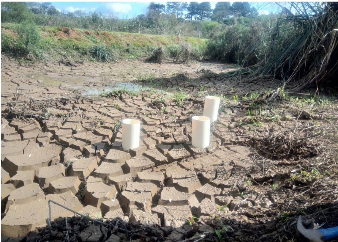
Figura 9 - Fixação dos tubos no leito de secagem para retirada das amostras.
