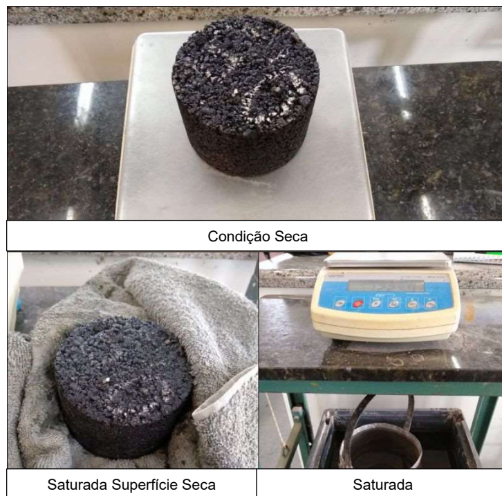
Figura 12 - Procedimento de ensaio de massa específica máxima
