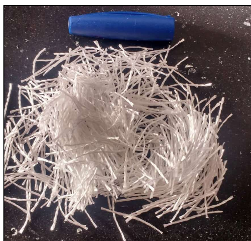
Figura 7 - Fibra de polipropileno cortada com 20 mm de comprimento
