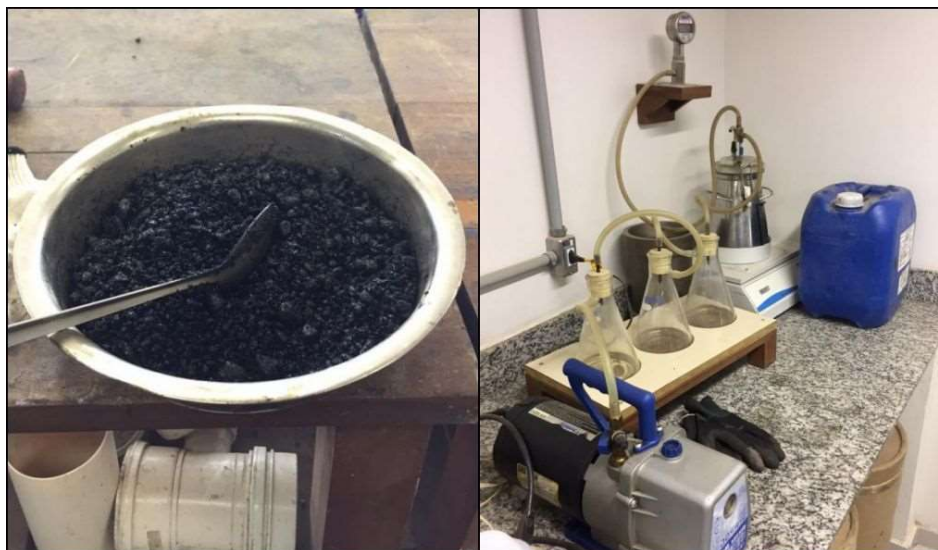
Figura 13 - Procedimento do ensaio de massa específica aparente
