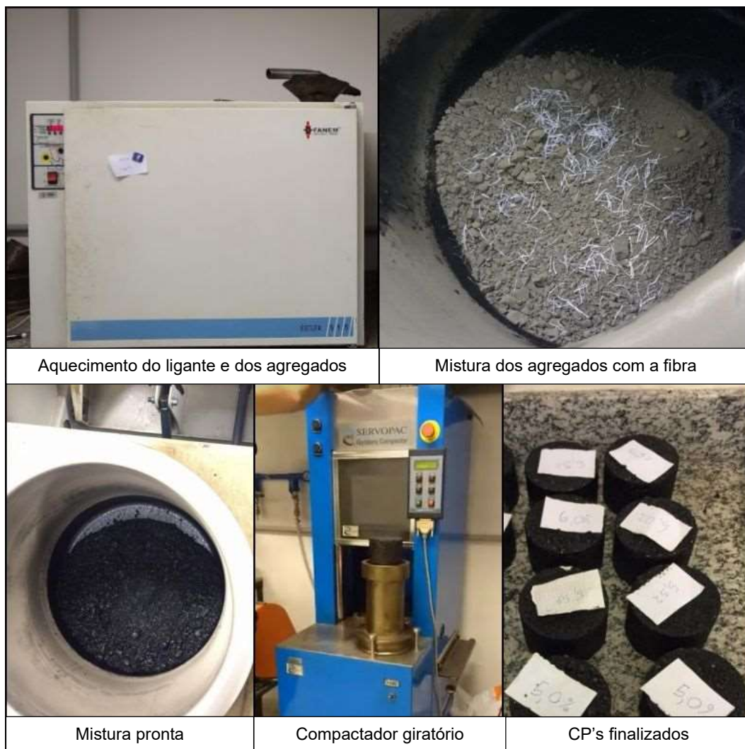
Figura 11 - Procedimento de mistura do CA
