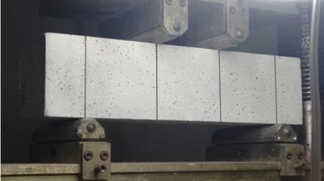
Figura 23 – Configuração utilizada para o ensaio de tração na flexão.
