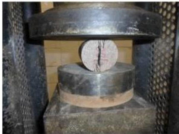
Figura 5 – Amostra de concreto rompida no ensaio brasileiro.
