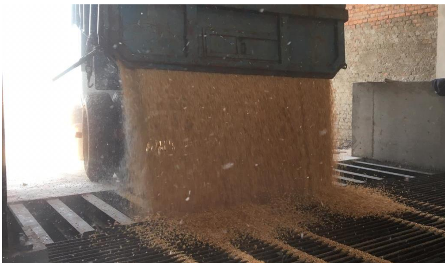
Figura 8 - Recebimento de grãos em unidade de armazenamento.
