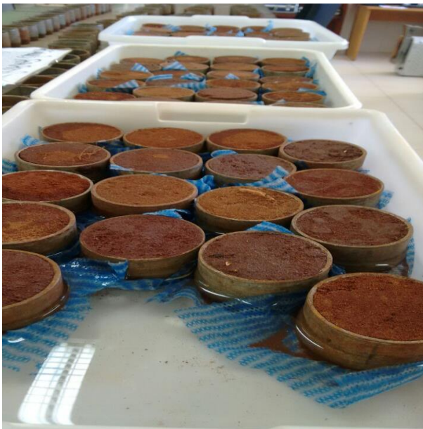
Figura 4 – a) Saturação prévia das amostras de solo por 24 horas;b) permeâmetro de carga constante utilizado para determinação da Ksat.
