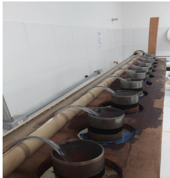
Figura 4 – a) Saturação prévia das amostras de solo por 24 horas;b) permeâmetro de carga constante utilizado para determinação da Ksat.
