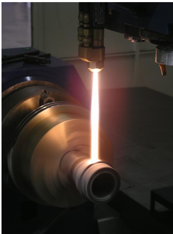
Figura 7 – Tocha de aspersão Praxair TAFE JP-5000 HP/HVOF utilizada na empresa Rijeza Metalurgia.
