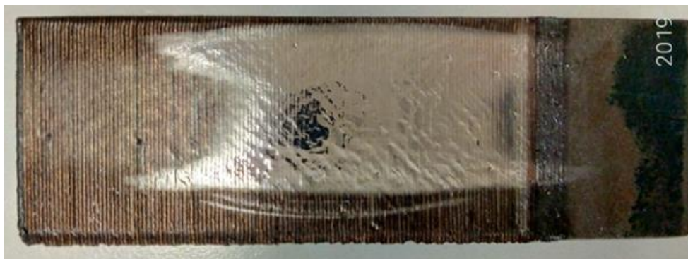
Figura 21 – Exemplo de corpo de prova após ensaio de desgaste abrasivo (ASTM G65).
