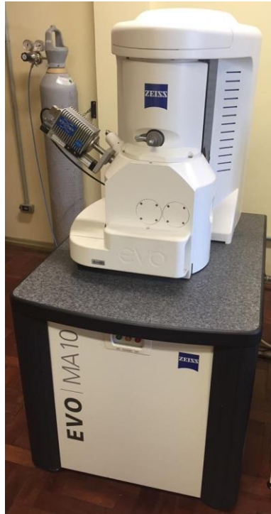
Figura 17 – Microscópio eletrônico de varredura Zeiss EVO MA10.
