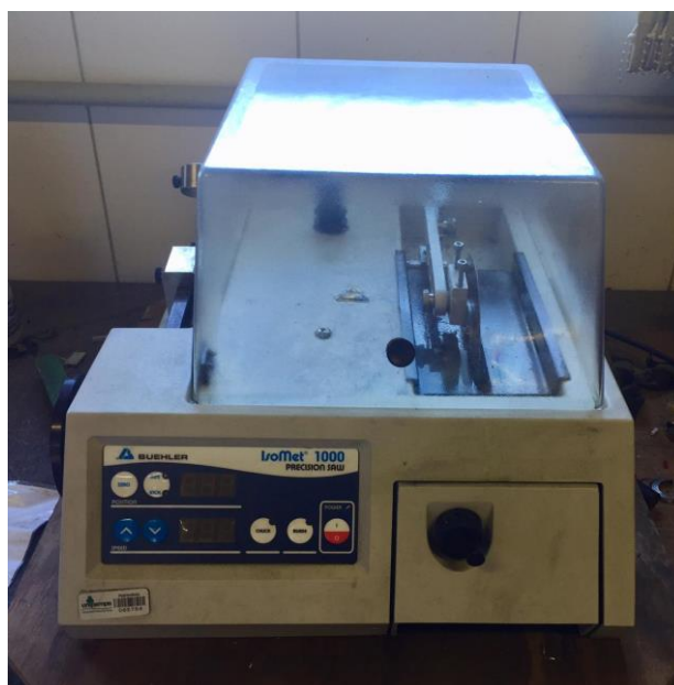
Figura 13 – Cortadora de precisão Buehler IsoMet 1000.
