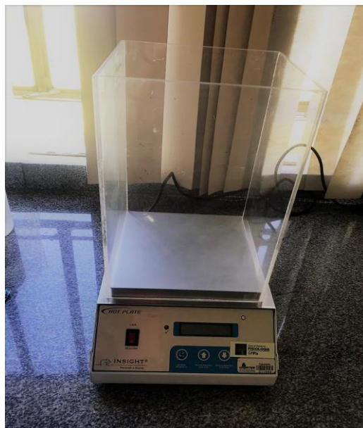
Figura 12. Placa quente (PQ). Aparato utilizado para análise da sensibilidade álgica dos animais. Fonte: Autoria própria (2019).
