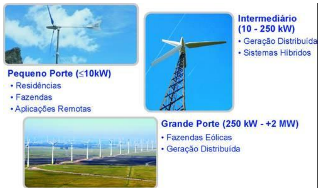
Figura 13 - Considerações sobre o tamanho dos aerogeradores e suas principais aplicações (Fonte: CRESESB, 2005)
