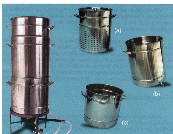
Figura 6- Panela extratora de suco. a) reservatório perfurado com tampa para colocar a uva, b) recipiente do suco c) depósito de água.
