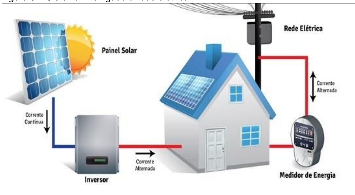
Figura 5 – Sistema interligado à rede elétrica
