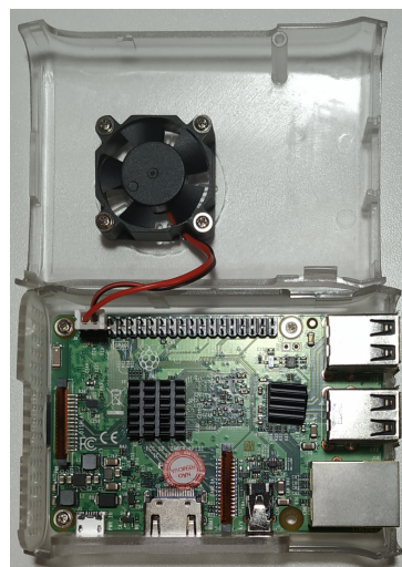
Figura 27 – Exemplo do Raspberry Pi 3 Model B+ utilizado.
