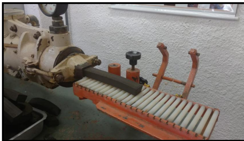
Figura 27- Extrusão e corte dos tijolos de cerâmica.
