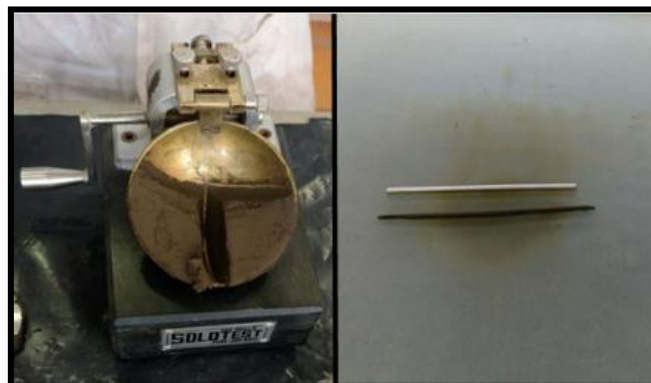
Figura 25- Ensaio de Limite de Liquidez (LL) e Limite de Plasticidade (LP).
