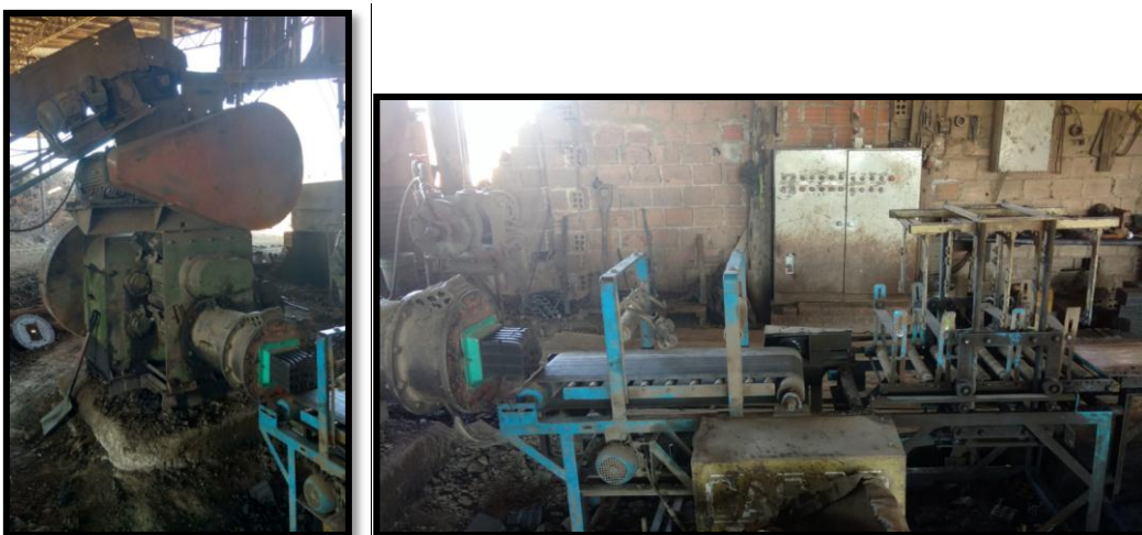
Figura 7- Extrusora de tijolos.
