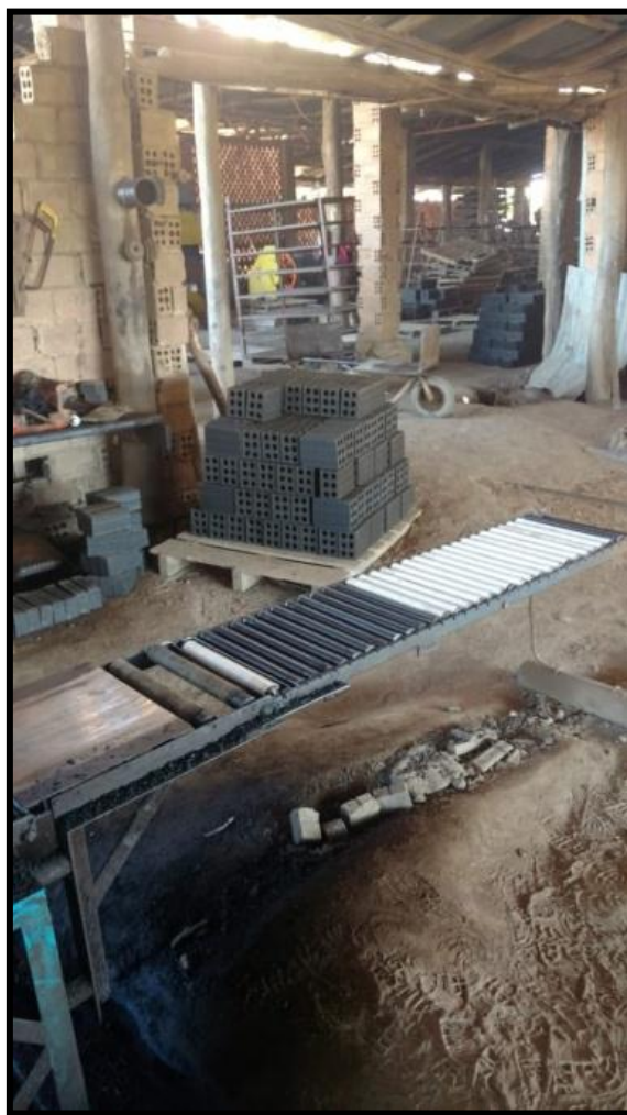
Figura 8 -Empilhamento de tijolos para secagem.
