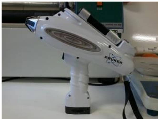
Figura 21 - Espectrômetro Portátil de Fluorescência de raios X utilizado na pesquisa Fonte: O autor, 2018.
