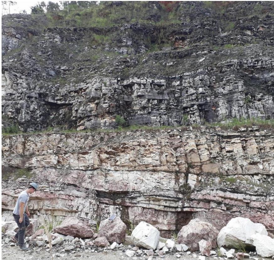
Figura 6 - Banca de rocha metacalcárias na Mina Mato Grande, evidenciando a variação na coloração dos mármores: róseo na porção inferior, amarelado ao centro, e branco acinzentado na bancada superior.
