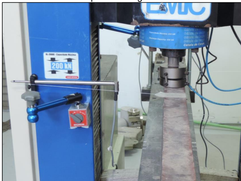
Figura 23 – LVDT fixo na máquina de ensaios universais, com fio de nylon preso a mesa superior da viga ensaiada.
