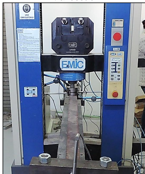
Figura 18 – Máquina de ensaios universais EMIC DL 20000, com o pistão sobre o travessão.
