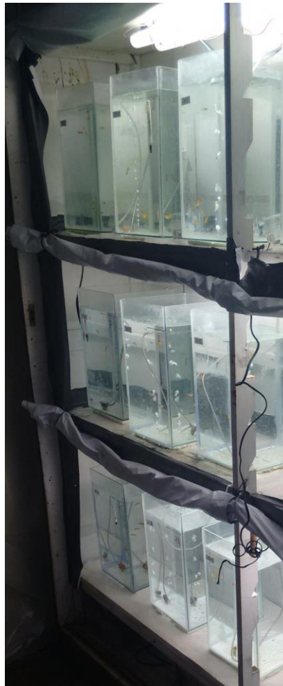
Figura 4. Instalações utilizadas no experimento, nove aquários com aerador, em estufa para controle da temperatura.
