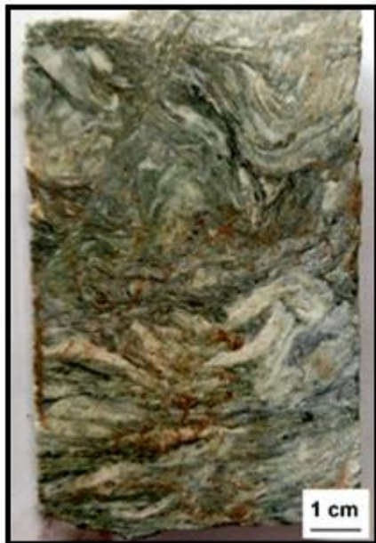
Figura 7 – Rocha cloritizada (tons esverdeados) com veios de carbonato dobrados.
