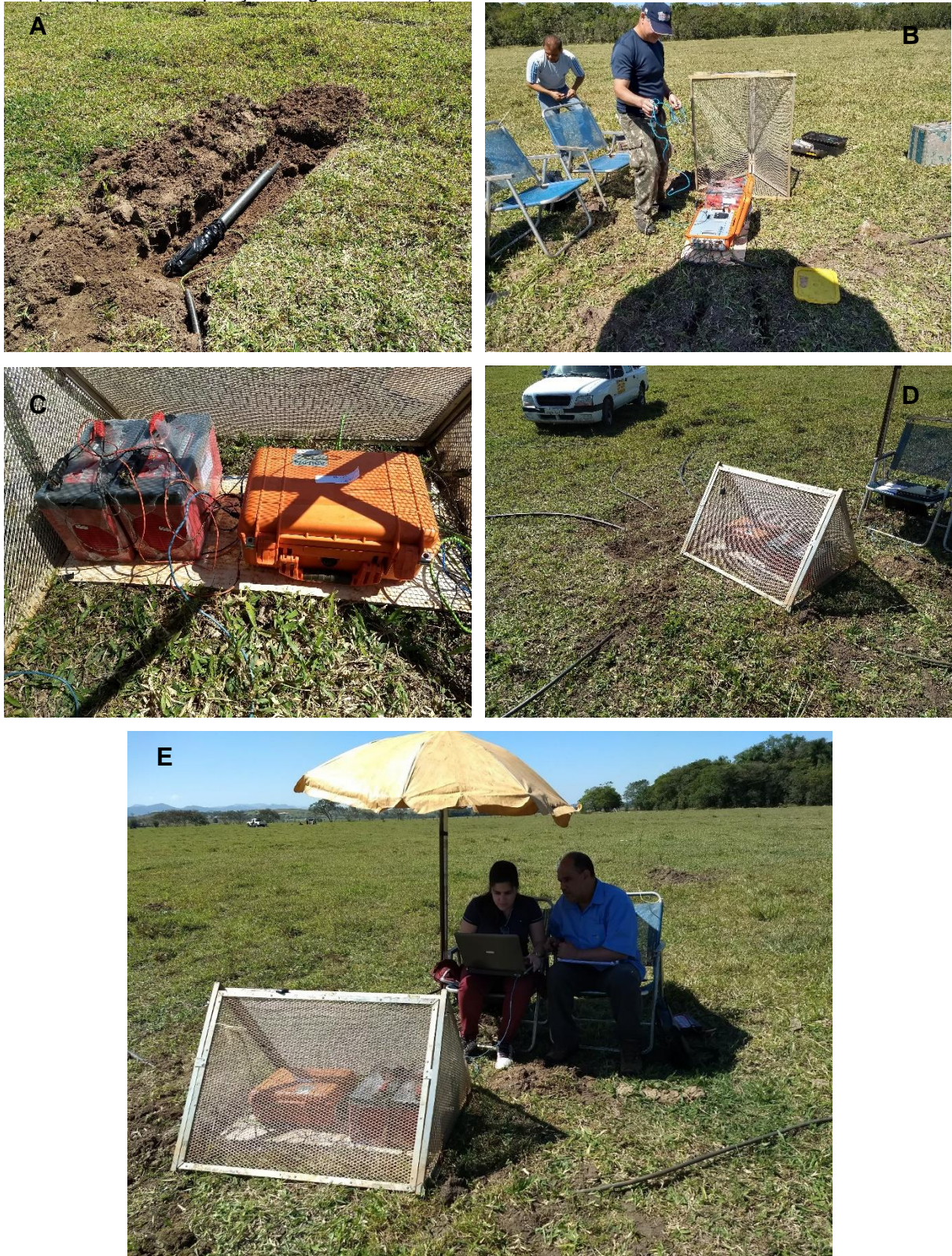
Figura 11 - Fotos da Instalação do equipamento em campo. Em A, a disposição do magnetômetro antes de ser enterrado. B mostra a conexão entre a central de processamento, os eletrodos e os magnetômetros. Em C e D, o equipamento pronto para começar a aquisição. Em E a realização do “disparo” (início da aquisição magnetotelúrica).
