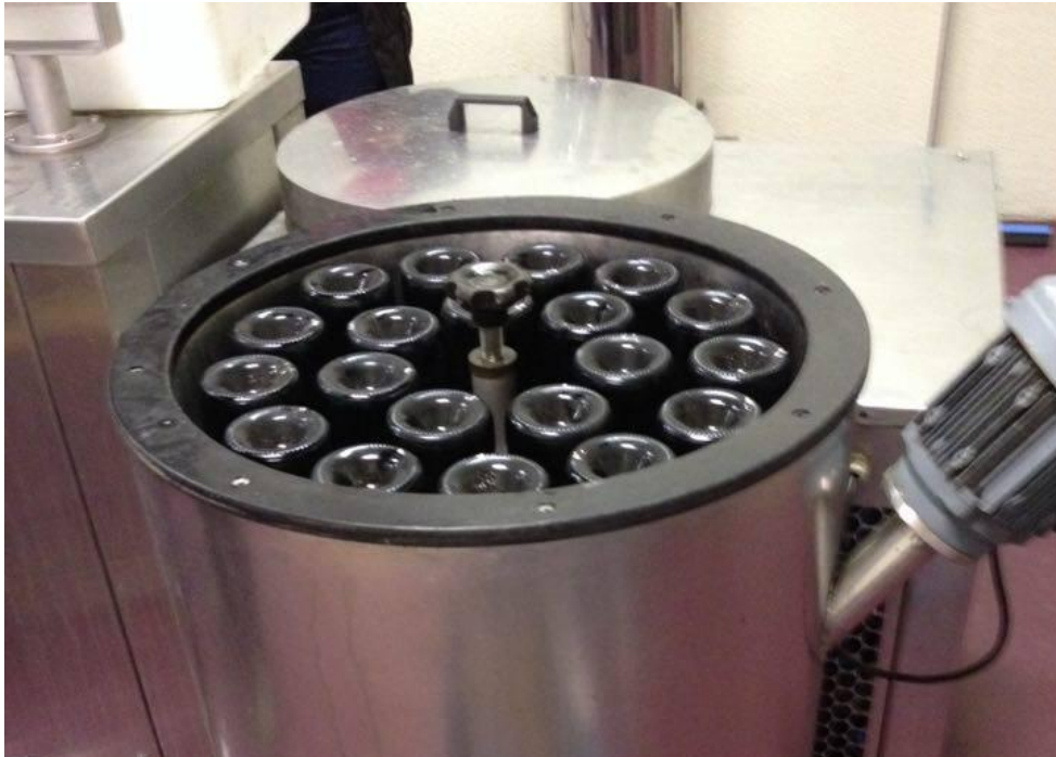
Figura 7 - Equipamento usado para o Degorgement
