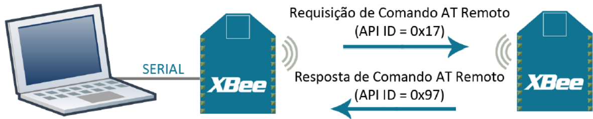
Figura 12 - Troca de pacotes API para execução remota de comandos AT
