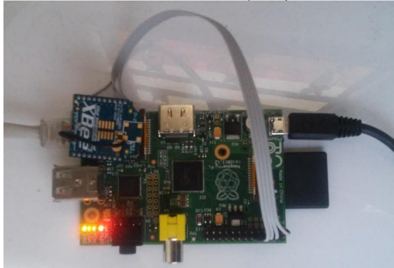
Figura 42 - Módulo XBee Pro2 conectado na Raspberry Pi
