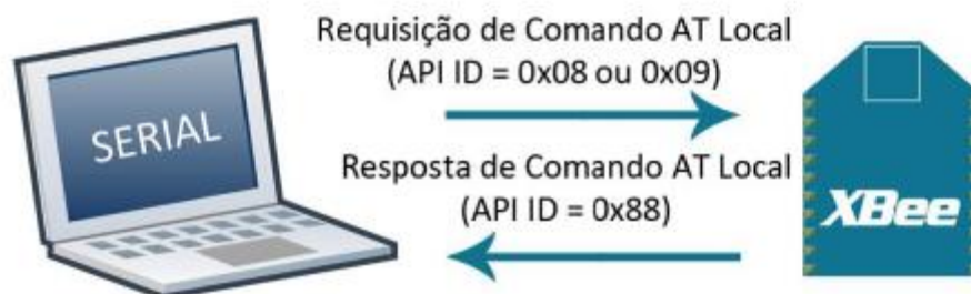
Figura 11 - Troca de pacotes API para a execução local de comando AT
