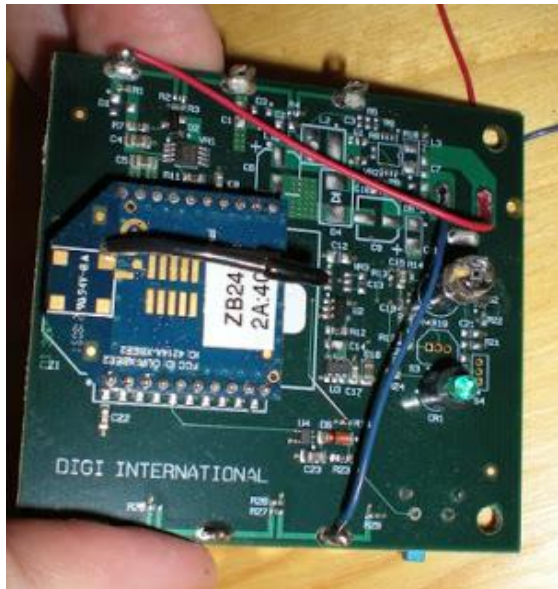
Figura 47 - adaptação do sensor XBee
