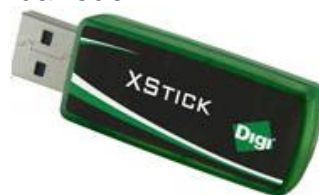
Figura 41 - XStick coordenador da rede
