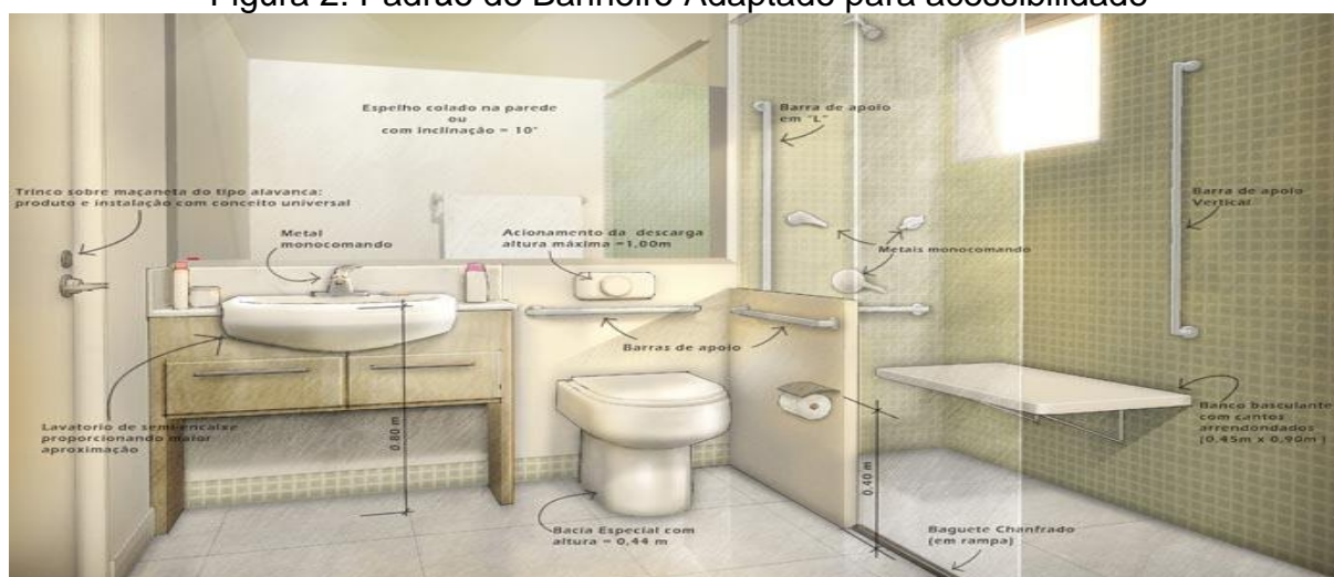
Figura 2: Padrão de Banheiro Adaptado para acessibilidade
