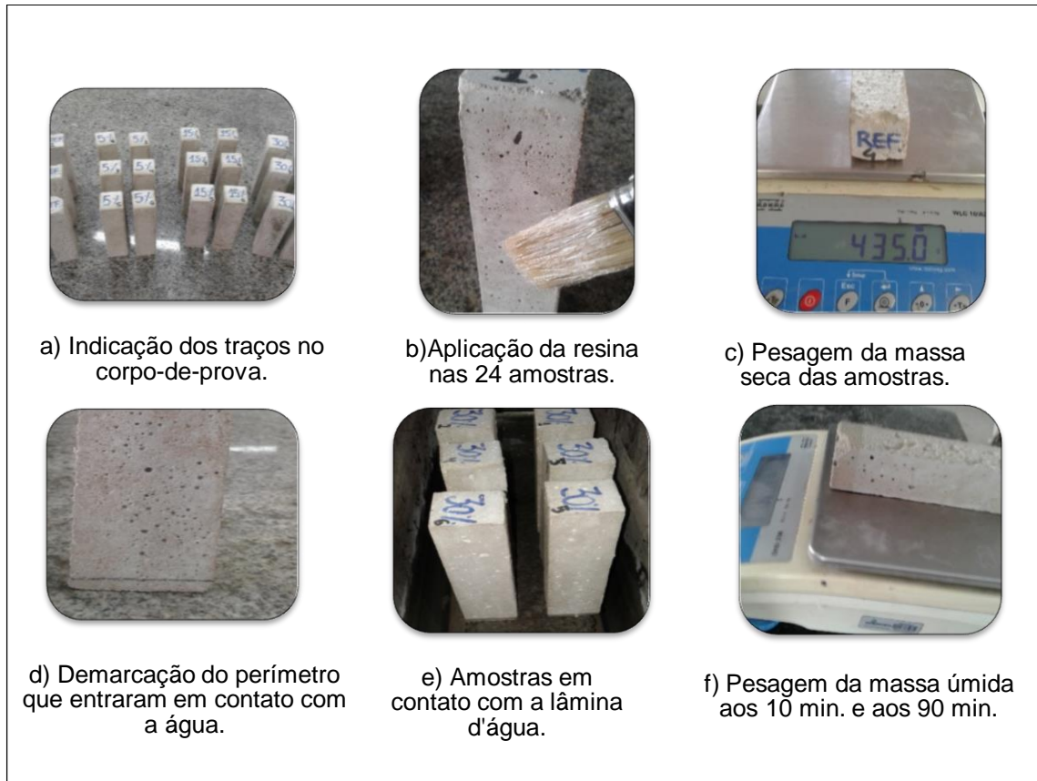
Figura 21 - Etapas da execução do ensaio de absorção por capilaridade
