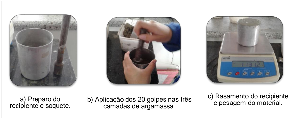
Figura 20 - Etapas do ensaio de densidade de massa e teor de ar incorporado
