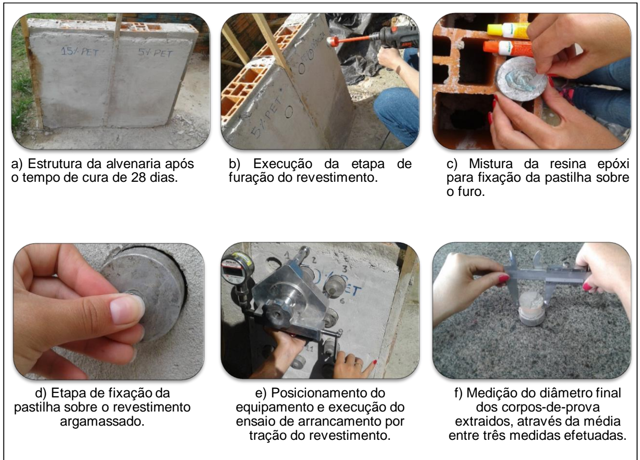
Figura 26 - Etapas de execução do ensaio de resistência a tração do revestimento
