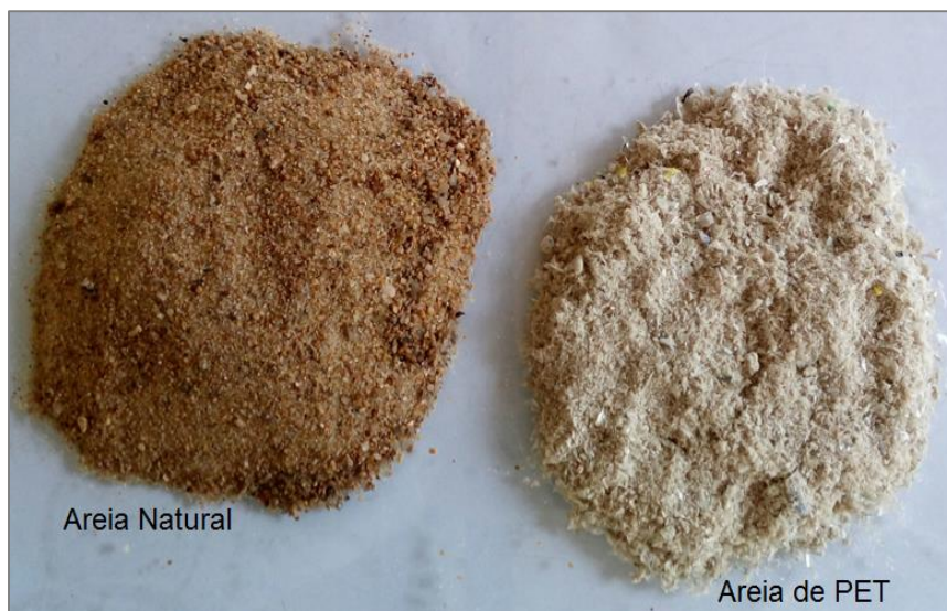
Figura 15 - Agregados miúdos destinados a produção das argamassas.
