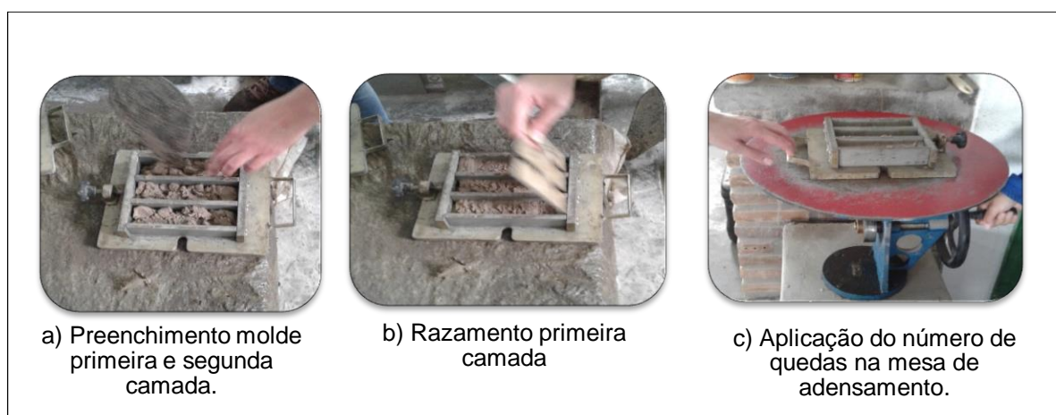
Figura 18 - Preparação dos corpos-de-prova prismático
