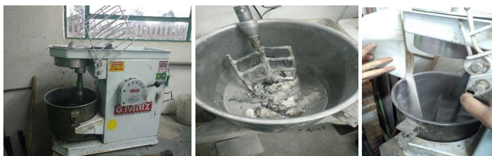
Figura 6 – Mistura da argamassa (a) misturador mecânico, (b) água com os aglomerantes e (c) adição das areias
