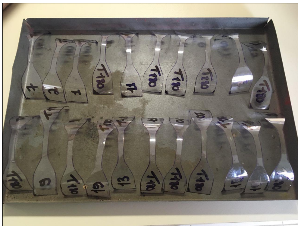
Figura 33 - Disposição das amostras para colocação na estufa
