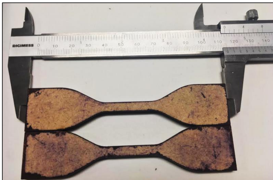
Figura 36 - Moldes em MDF cortados a laser
