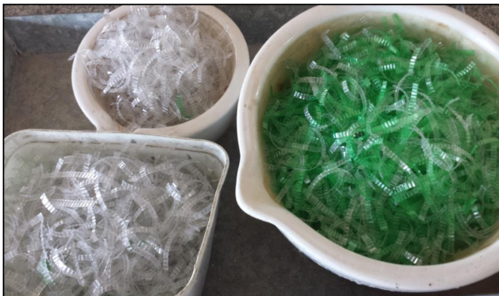
Figura 30 - Fibras de politereftalato de etileno com tratamento mecânico
