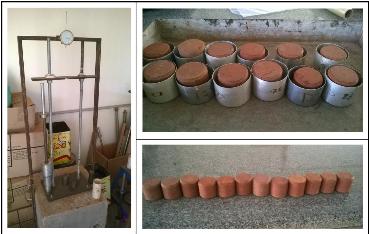
Figura 14 – Execução do Ensaio de Mini-Proctor
