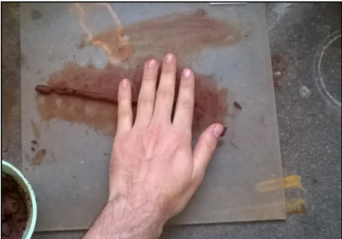
Figura 11 – Execução do Ensaio de Limite de Plasticidade
