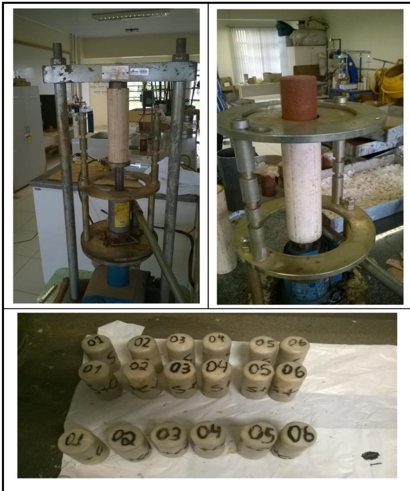
Figura 15 – Moldagem dos Corpos de Prova para Ensaio de Compressão Simples
