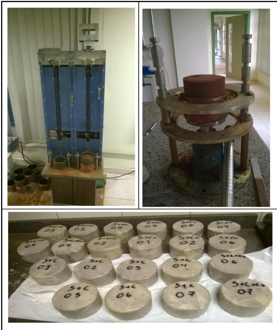
Figura 16 – Moldagem dos Corpos de Prova para Ensaio de Tração por Compressão Diametral
