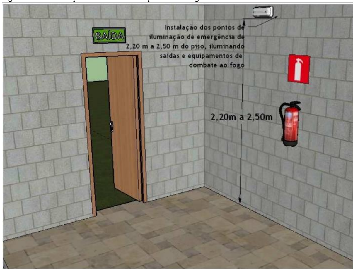
Figura 51 – Instalação de uma iluminação de emergência
